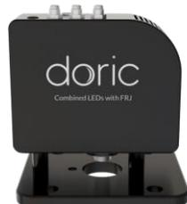
複数のLED光源を内部でカップリングして、ロータリージョイントとなっている1つのFCコネクタから出力するモデルです。接続する光ファイバーパッチコードがねじれないため、自由行動下で複数のオプションを制御する用途に適しています。制御は波長ごとに独立して行うことができ、複数の波長を同時に出力することも、1つの波長だけを出力することもできます。
